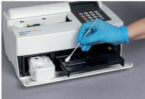
Einen Wattetupfer mit destilliertem Wasser anfeuchten (nicht zu nass) und damit die Rillen der Reagenzträger auswischen. Die schwarze Abdeckung (hinter den Rillen) vorsichtig anheben und darunter sauber wischen. Darauf achten, dass der Staub nach vorne gewischt wird und nicht nach hinten ins Geräteinnere.
