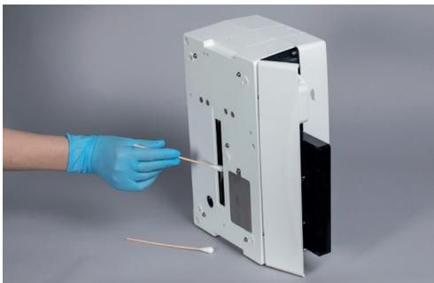
Ein Wattestäbchen mit destilliertem Wasser anfeuchten. Damit die Glasplatte (optisches Fenster) im Geräteinnern reinigen. Mit einem trockenen Wattestäbchen nachwischen. Die Glasplatte darf keine Staub- oder Wasserrückstände mehr aufweisen.
