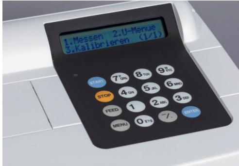
Auf Display 2. U-Menue anwählen. Im Untermenü wird 3. Wartung angewählt. Die Fronttür öffnet sich, nun das Gerät am Hauptschalter ausschalten und vom Strom trennen.
