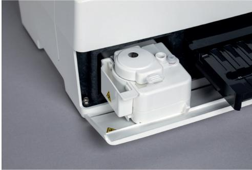
Spitzenabfallbehälter und Schutzdeckel von der Zentrifuge entnehmen. Mit Desinfektionsmittel reinigen und anschliessend mit Wasser gut spülen und trocknen. Beides nach dem Trocknen wieder montieren.
