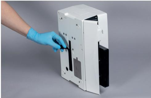
Spitzenabfallbehälter entfernen. Gerät vorsichtig hochkant aufstellen und die Gummiabdeckung an der Geräteunterseite entfernen.
