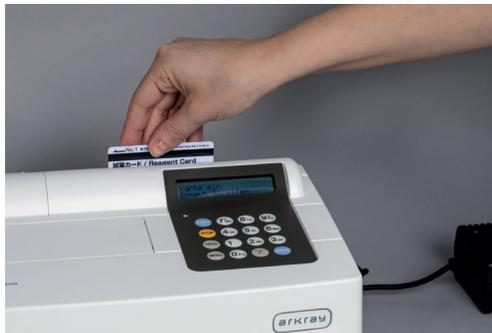
1. Karte auswählen auf Display. Die Meldung «Karte ein» erscheint. Reagenzkarte aus der Teststreifenschachtel nehmen und die Karte in das Magnetlesegerät einführen und die Karte nach rechts ziehen.
