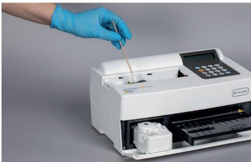
Ein Wattestäbchen mit destilliertem Wasser tränken. Damit die Gummiplatte im Geräteinneren abwischen. Falls die Gummiplatte feucht ist, diese mit einem trockenen Wattestäbchen nachwischen.
